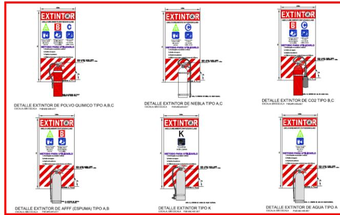
El contratista deberá considerar en su oferta las canastas a proveer en los casos en que no se cuente con estas y no sea posible la instalación del extintor mediante ganchos atornillados a la pared. El diseño de la canasta se muestra en la siguiente imagen.
